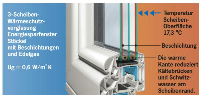
Das kennt jeder: Der Wohnraum ist mit ca.  $20^{\circ}\text{C}$  Raumtemperatur angenehm warm. Nähert man sich aber dem Fenster oder hält die Hand an die Scheibe, wird sofort die Kältestrahlung von außen bemerkbar. Mit der 3-fach-Verglasung wird diese „Kältestrahlung“ extrem reduziert. Auch direkt im Fensterbereich herrscht Wohlfühlklima.
